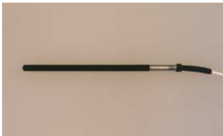
図2 ペンシル型電離箱チェンバー PC-4P（キャピンテック社製）
