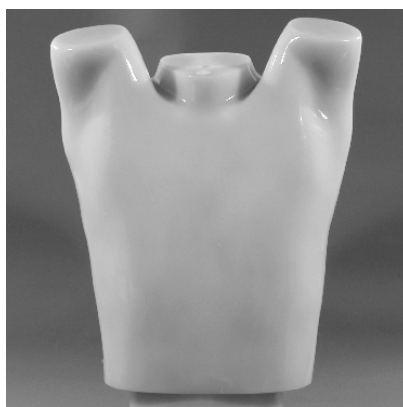
図 1 胸部 CT 検診品質管理用ファントム LSCT-001（京都科学社製）
