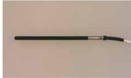
Fig.2 ペンシル型電離箱チェンバー-PC-4P (キャピンテック社製)
